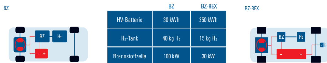
Abbildung 6: Funktionsweise von BZ-Hybrid (links) und BZ-REX Fahrzeugen (rechts) [NOW GmbH]
